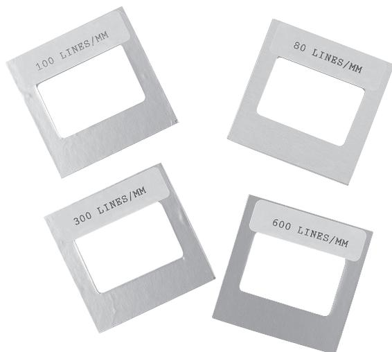
Reticolo di trasmissione per analisi spettroscopiche e per esperimenti sulla diffrazione e sull'interferenza.
