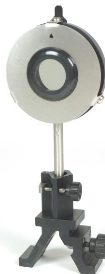
Fig. 1: Filtro polarizzatore montato sulla piastra a lunghezza d'onda /4.
