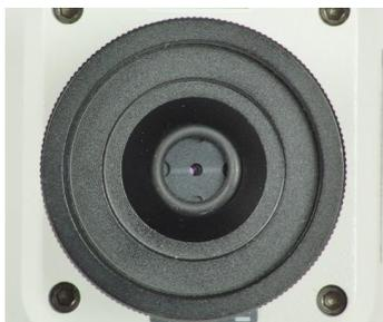
Fig. 1: Diaframma inserito nella lente di focalizzazione e fissato con l'O-Ring.
