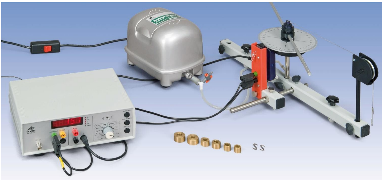
Fig. 1: Disposizione di misura per l'analisi di movimenti di rotazione uniformemente accelerati
