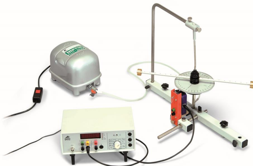
Fig. 1: Disposizione di misurazione per la determinazione del momento d'inerzia in base al metodo delle oscillazioni di torsione
