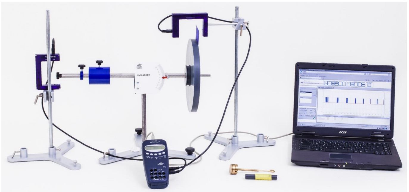
Fig. 1: Disposizione di misurazione per la precessione di un giroscopio (senza massa supplementare agganciata).
