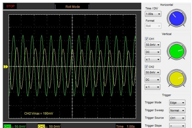
Fig. 9: Le componenti oscillatorie del pendolo a filo in oscillazioni circolari
