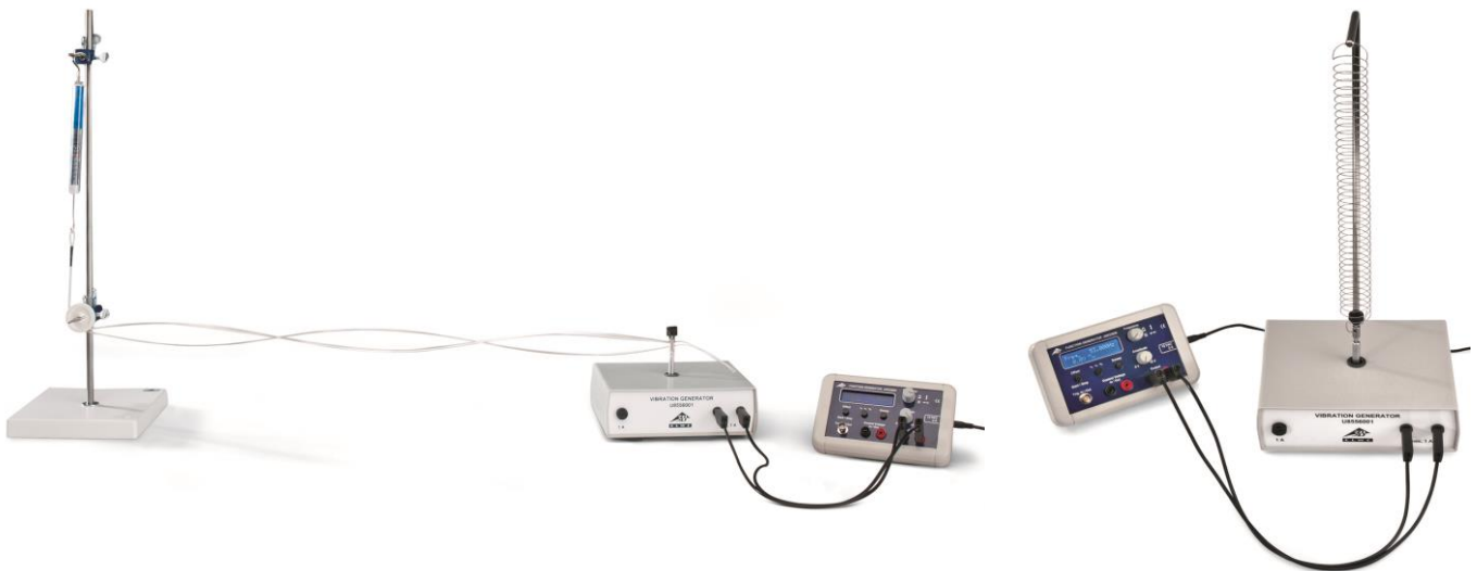
Fig. 1: Disposizione per la misurazione durante l'analisi di onde stazionarie su una corda tesa (a sinistra) e su una molla a elica sotto tensione (a destra).
