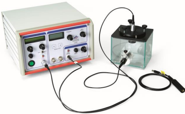
Fig. 3: Struttura di misura della diffrazione della luce su un reticolo di fase generato in un liquido con onde ultrasonore
