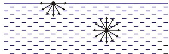
Fig. 1: Forze di interazione che agiscono su una molecola di liquido in superficie e su una molecola all'interno del liquido da parte delle rispettive molecole adiacenti
