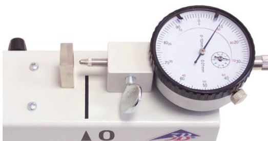
Fig. 5: Inserire completamente il comparatore a quadrante nell'adattatore e fissarlo con la vite ad alette.
