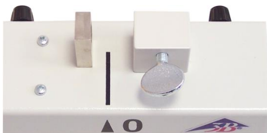
Fig. 4: Avvitare l'adattatore per il comparatore a quadrante.
