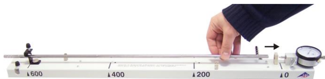
Fig. 7: Collocare il tubo di prova con l'estremità chiusa nel cuscinetto di guida. Prestare attenzione a che la flangia sia rivolta all'indietro.
