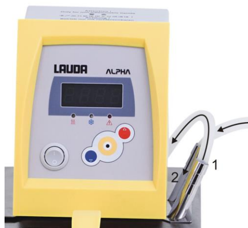
Fig. 10: Mandata (1) e ritorno (2) del kit di circolazione della pompa.
