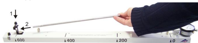
Fig. 6: Fissare il cuscinetto fisso mediante la vite a testa zigrinata in corrispondenza della marcatura 600 sul dispositivo di dilatazione lineare. Posizionare il tubo in acciaio di prova con l'estremità aperta nel cuscinetto fisso.
