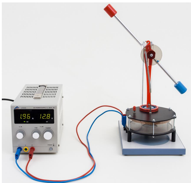
Fig. 5: Struttura per il funzionamento del motore ad aria calda come motore termico mediante riscaldamento elettrico
