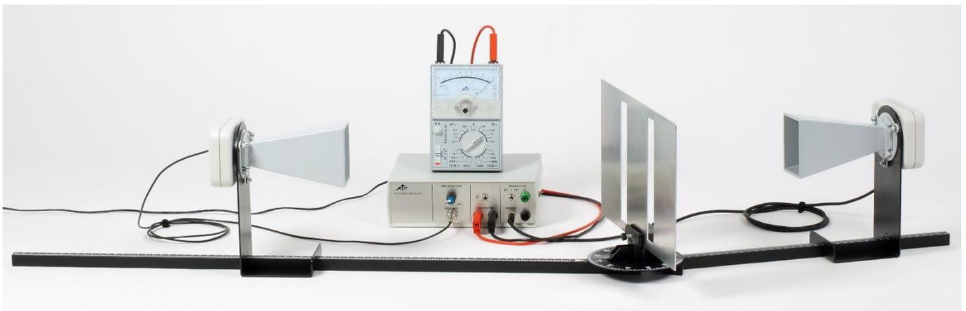
Fig. 1: Disposizione per la misurazione nella diffrazione delle microonde da doppia fenditura
