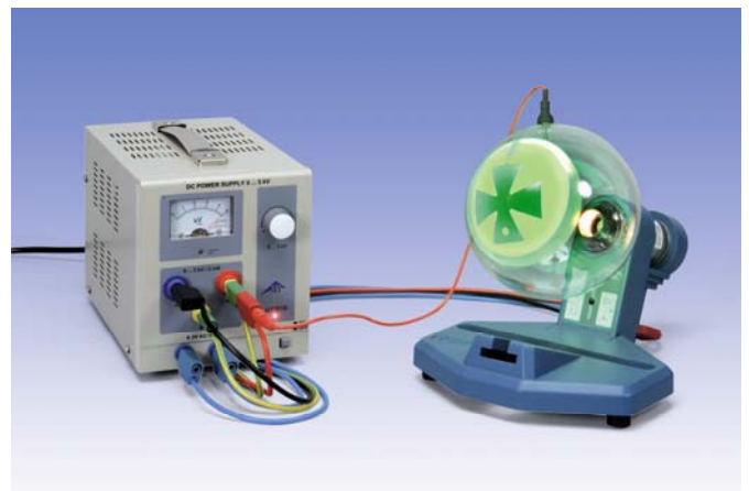
Fig. 2 Struttura sperimentale per dimostrare la diffusione rettilinea di elettroni mediante tubi a croce di Malta
