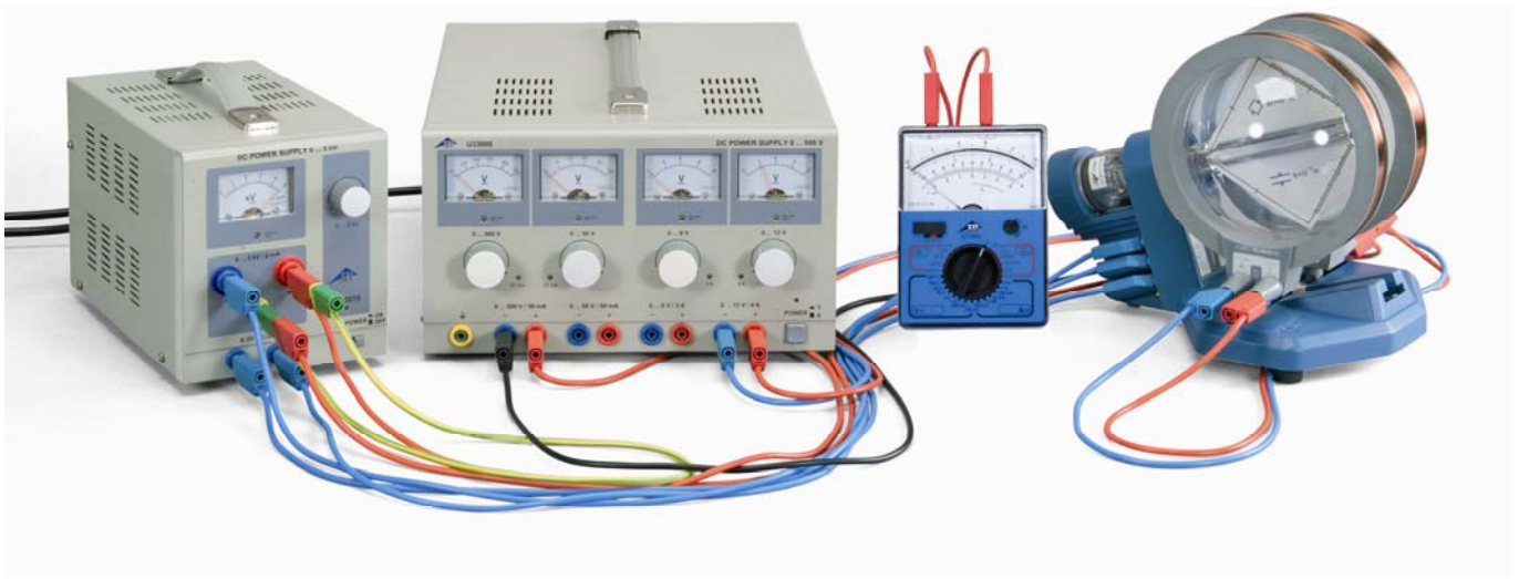
Fig. 2: struttura sperimentale per la verifica della deviazione nel campo elettrico e magnetico.
