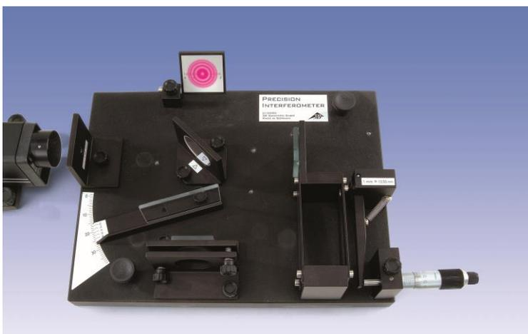
Fig.1 Struttura di misura per la determinazione dell'indice di rifrazione del vetro con un interferometro di Michelson
